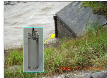
水位計設置事例
