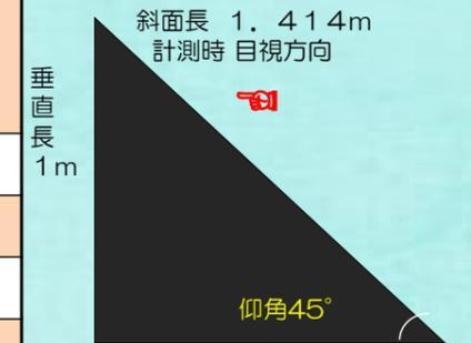
説明) 左図は仰角45°の法面を示します。この面で→方向で1mを計測する場合1.414mの量水標が必要です。
