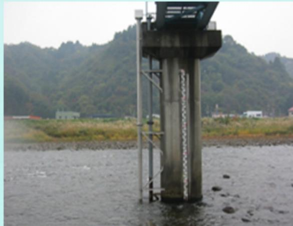
(フロート式水位計と併設)
